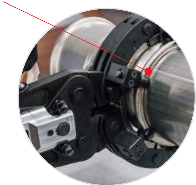
Guide sopra la sede di contenimento dell'o-ring Guides over the o-ring groove
