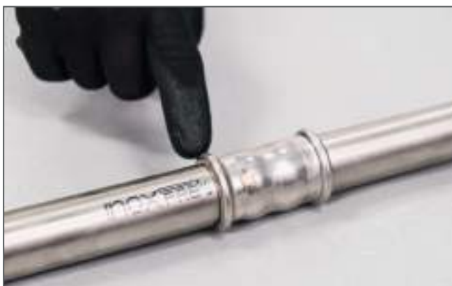
Controllo della pressatura / Checking the press connection
